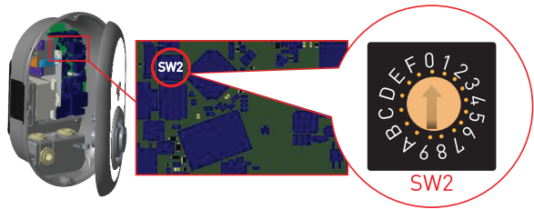
Abb.12: Drehschalter SW2 zur Ladestromeinstellung
