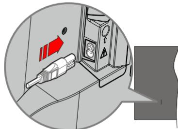
Stecken Sie ein Ende (den Zwei-Loch-Stecker) des mitgelieferten abnehmbaren Netzkabels wie oben gezeigt in den Netzkableinlass auf der Rückseite des TV-Geräts. Stecken Sie dann das andere Ende des Netzkabels in die Steckdose.
